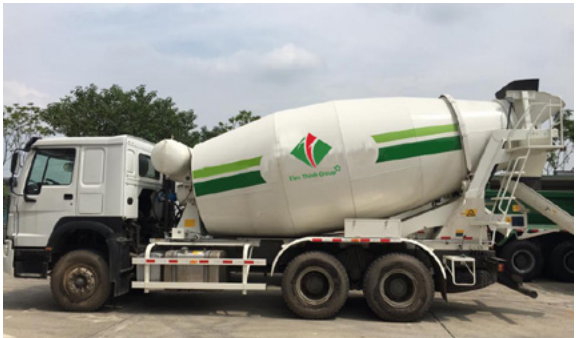
Xe trộn bê tông
