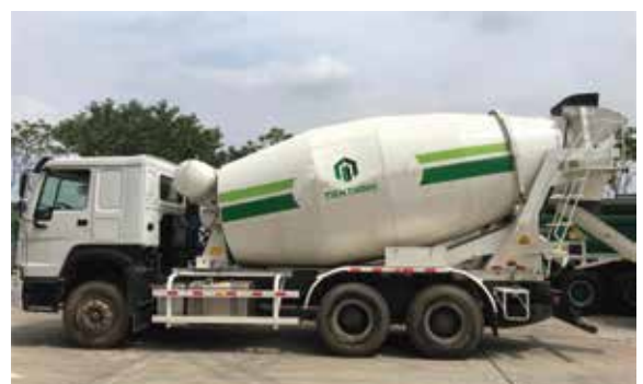
Xe trộn bê tông
